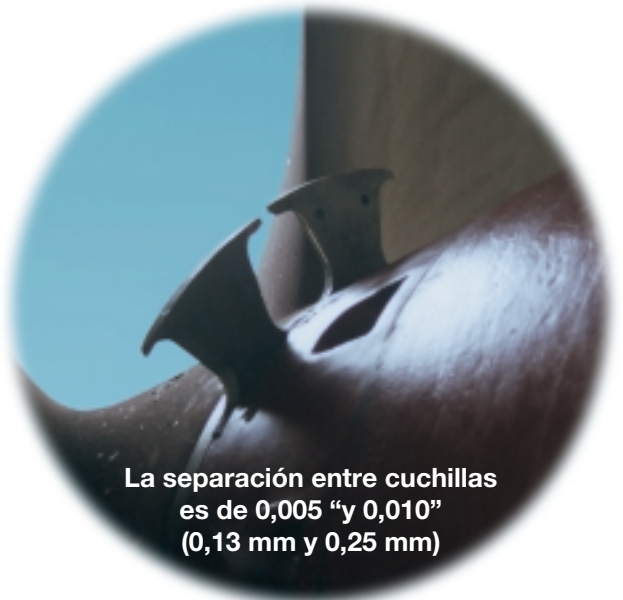
Figura 6. Instalación de cortadora (FM) montada al ras con las Cortadoras rotativa y Estacionaria salientes. En las transmisiones en forma de Z el espacio entre la hélice y el Guarda-cabos puede ser tan pequeño como 0,050" (1,27 mm). el efecto end play (movimiento axial del eje) en las transmisiones en forma de Z es aproximadamente de 0,001" á 0,005" (0,025 mm á 0,127 mm)
