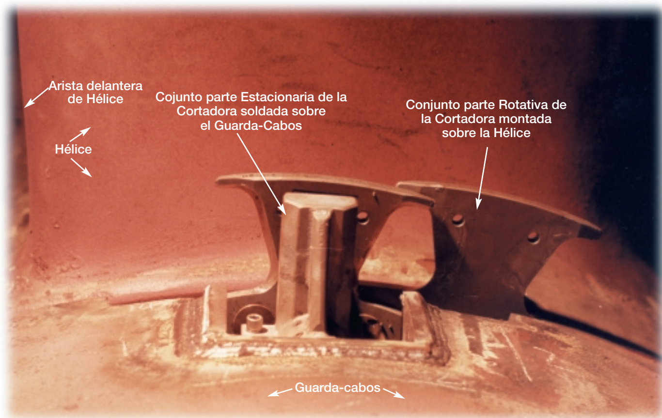
Instalación completa de Cortadora Spurs en barcos grandes
